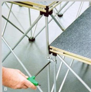
3. Verbinden Sie die Platten mit dem Lockingsystem (A), unterschiedliche Höhen mit der Verbindungsklemme (B).
